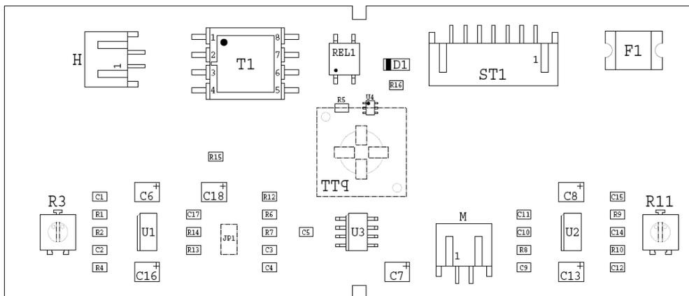
Ist Jumper JP1 gesetzt liefert der Mikrofonausgang 5 mV, ansonsten 500 mV. Mit R11 wird der Mikrofonpegel eingestellt. Mit R3 kann der Hörerpegel eingestellt werden.
